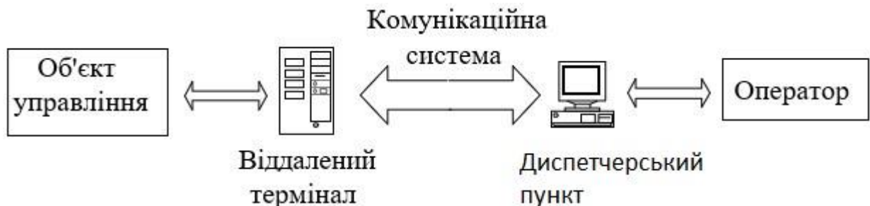
Рисунок 3.1 – Основні структурні компоненти SCADA системи
