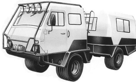
Рисунок 2.4 – Зчленований снігоболотохід СБХ-2 «Атака»: вантажопідйомність – 0,5 т, двигун – дизельний, 52,6 к.с., швидкість – до 45 км/год
