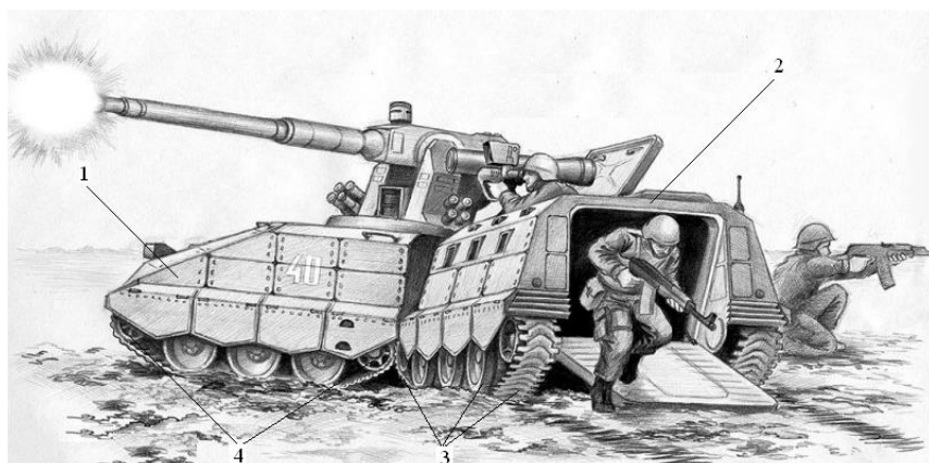
Рисунок 6.1 – Загальний вигляд дволанкової важкої гусеничної бойової машини
