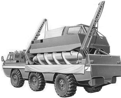
Рисунок 2.3 – Снігоболотохід 2906 комплексу «Синяя птица» в кузові вантажного колісного транспортеру 4906. Швидкість по дорозі – до 80 км/год, на плаву – до 9 км/год
