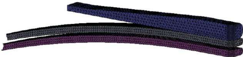
Рисунок 4.48 – Сітка моделі з віртуальним болтом
