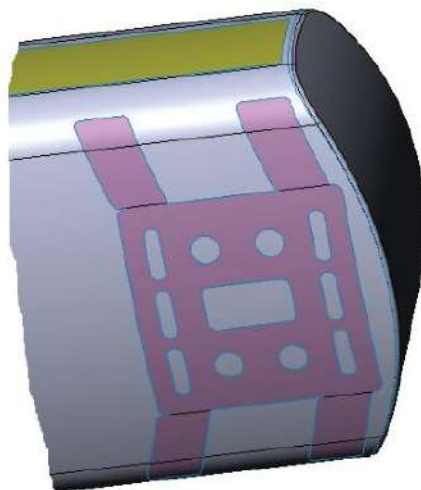
Рисунок 5.13 – Оформлення підкладних листів між ємністю та опорою сидла
