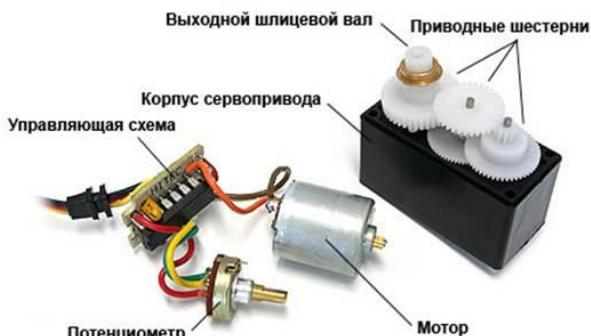
Рисунок 5.2 – Конструкція сервоприводу
