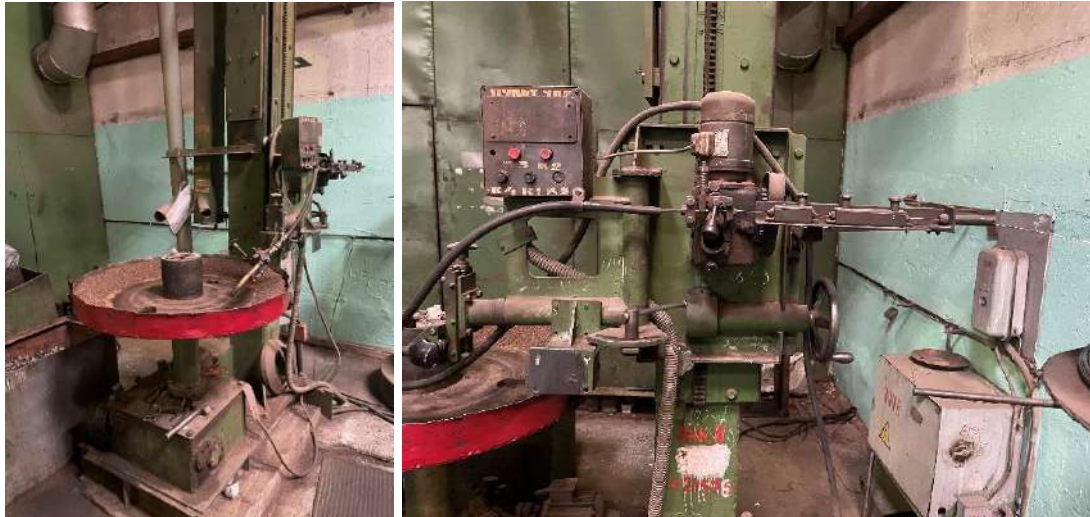
Рисунок 2.1 – Автоматична установка для наплавленн коліс трамваю
