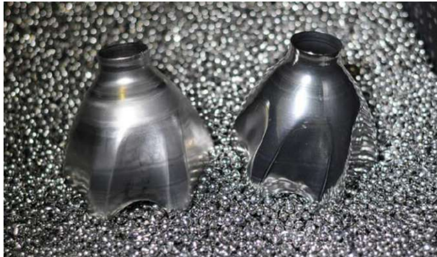
Рисунок 5.12 – Сталевий носій-наповнювач для віброгалтовочної машини [13]
