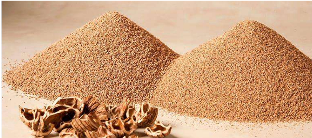
Рисунок 5.13– Органічний носій-наповнювач для віброгалтовки [13]
