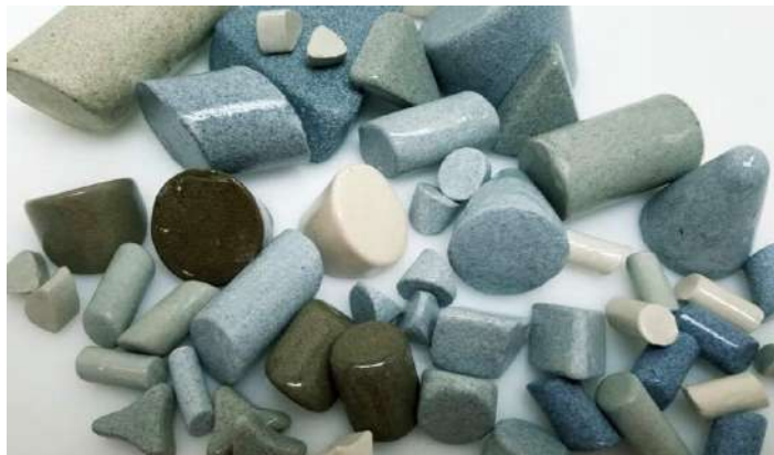
Рисунок 5.10 – Керамічний носій-наповнювач для віброгалтовки [13]
