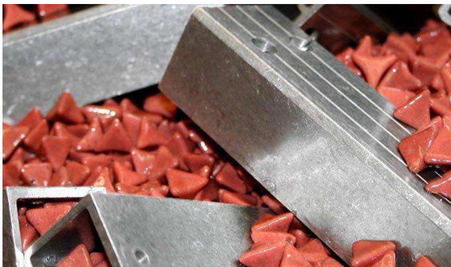
Рисунок 5.11– Пластиковий носій-наповнювач для віброгалтовочної машини [13]
