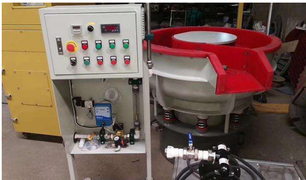
Рисунок 5.9 – Віброгалтовочна машина з пультом керування [13]
