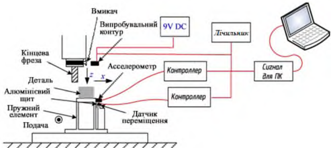
Рисунок 2.12 - Експериментальна установка для дослідження коливань при кінцевому фрезеруванні [40]
