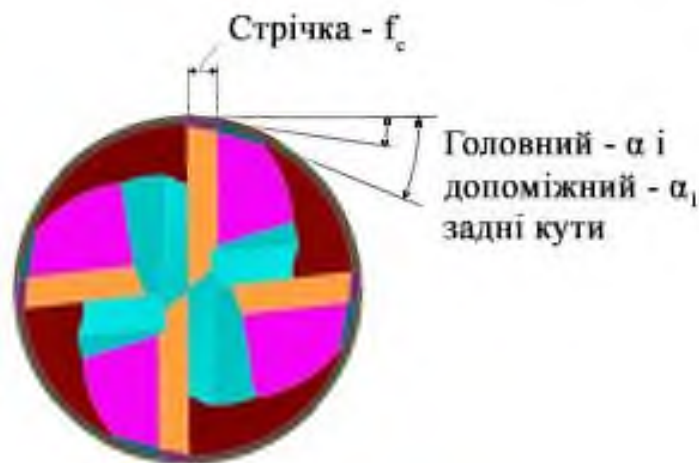
Рисунок 1.7 - Геометрія різальної частини фрези [33]
