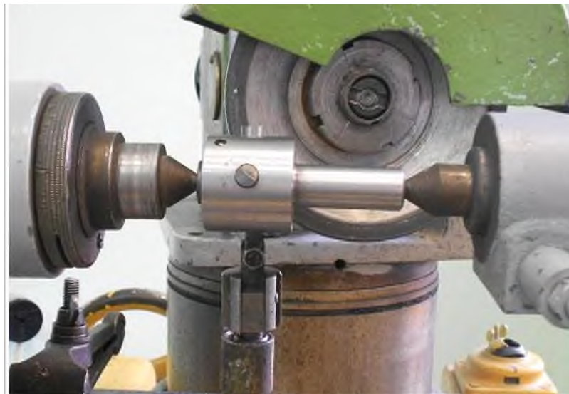
Рисунок 2.17 - Пристосування для заточування різальної кромки зуба експериментальної фрези [18]
