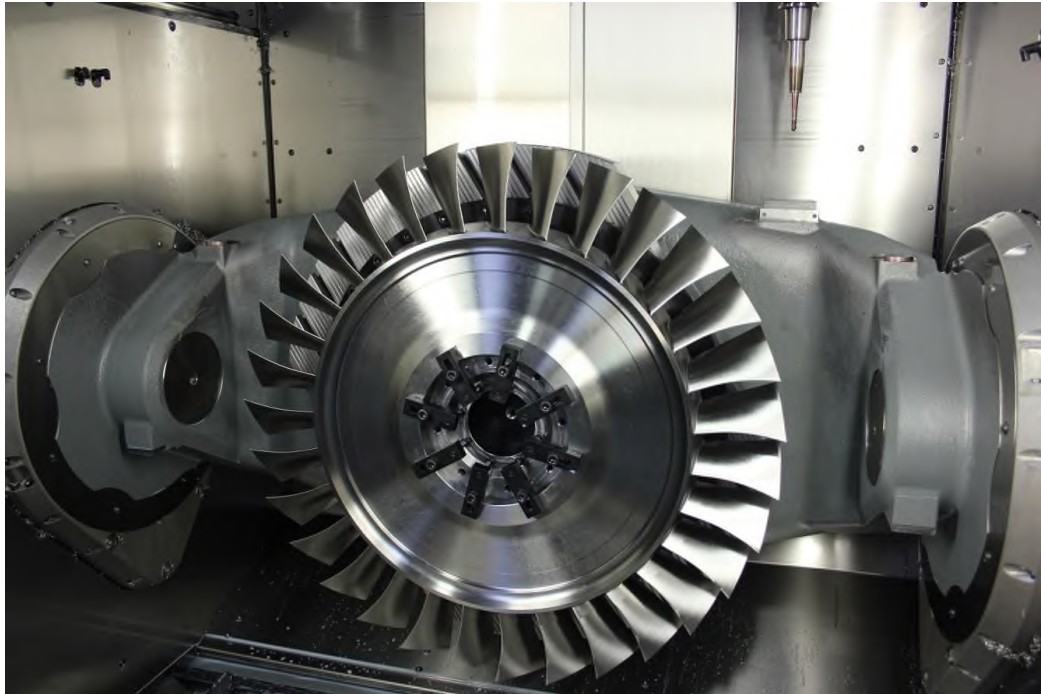
Рисунок 2.1 - Лопатки моноколеса «блиск»
