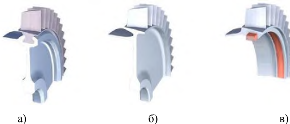
Рисунок 2.2 - Види коліс, які використовуються в машинобудуванні (а - диск з лопатками, б - «блиск», в - «блінг») [32]
