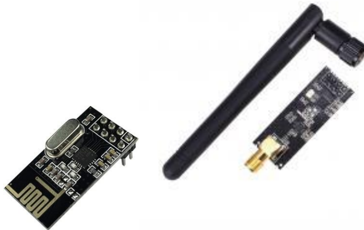
Рисунок 2.5 – Зовнішній вигляд двох варіантів реалізації модулів NRF24L01
