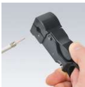
Рисунок 3.16 - Зняття ізоляції з кабелю
