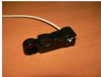
Рисунок 3.14 - Кабель вставлений в інструмент для зачистки
