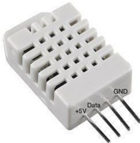
Рисунок 3.1 – Давач температури та вологості DHT22
