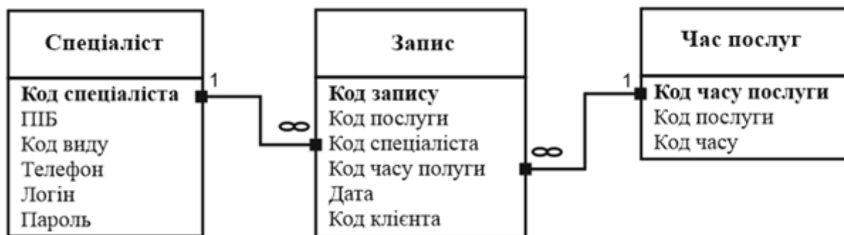
Рисунок 2.13 – Схема зв'язку сутностей «Спеціаліст» та «Час послуг»
