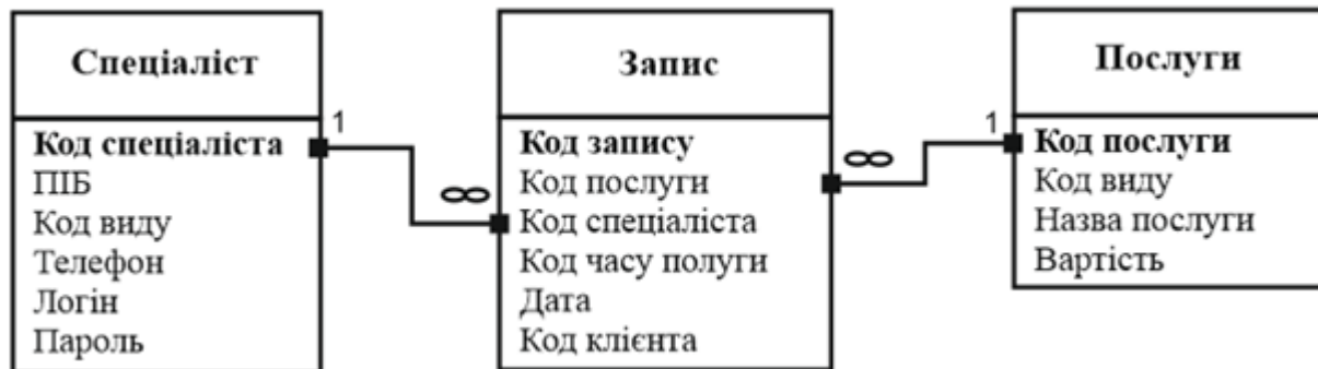
Рисунок 2.12 – Схема зв'язку сутностей «Спеціаліст» та «Послуги»
