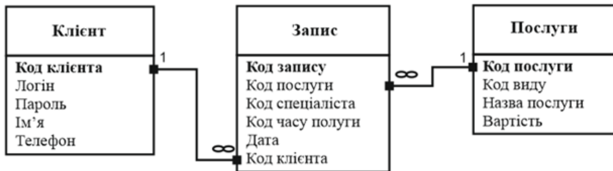
Рисунок 2.10 – Схема зв'язку сутностей «Клієнт» та «Послуги»
