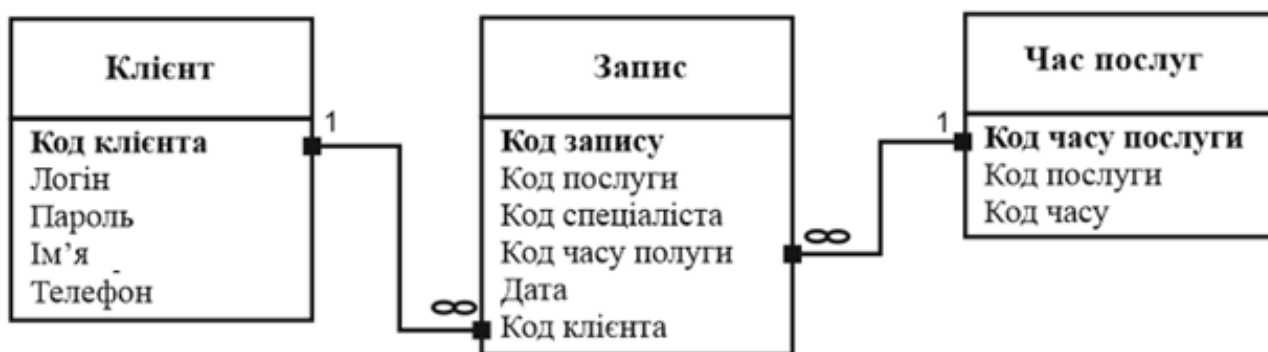
Рисунок 2.11 – Схема зв'язку сутностей «Клієнт» та «Час послуг»
