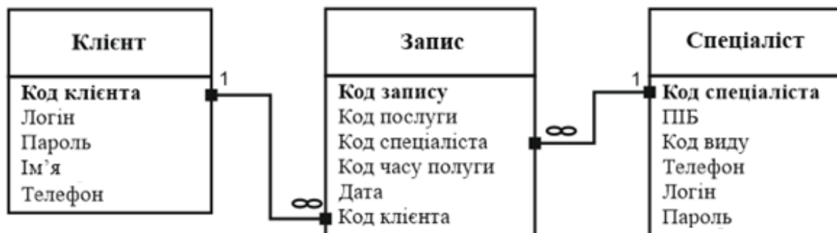
Рисунок 2.9 – Схема зв'язку сутностей «Клієнт» та «Спеціаліст»
