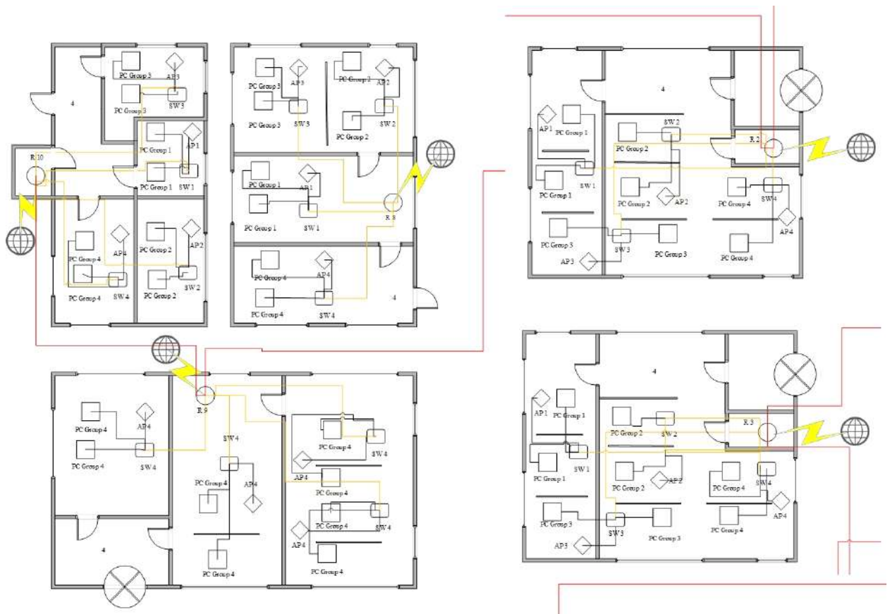
Рисунок 3.4 - Монтажна схема конструкторського та головного відділу
