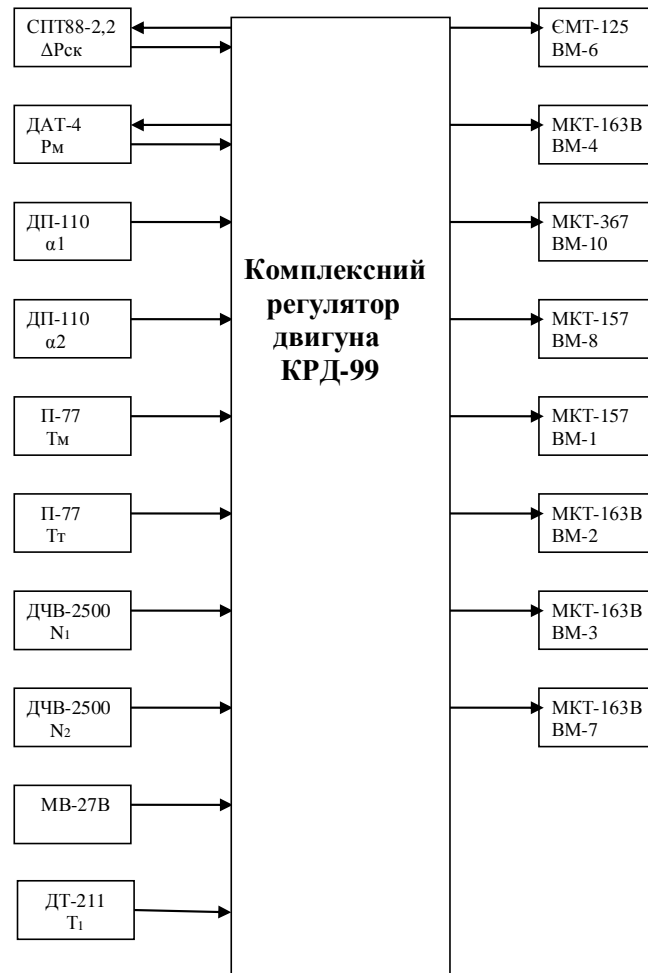
Рисунок 1.2 – Структурна схема системи КРД-99
