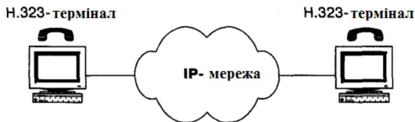
Рисунок 1.6 – Спрощений сценарій IP-телефонії "комп'ютер-комп'ютер"
