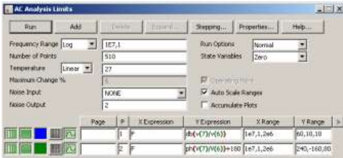
Рисунок 2.13 – Завдання виводу логарифмічних частотних характеристик
