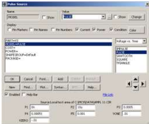
Рисунок 3.11 – Завдання параметрів імпульсного джерела сигналів в ОСЧ
