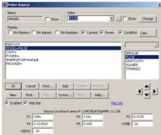
Рисунок 3.2 – Завдання параметрів імпульсного джерела сигналів в ОНЧ
