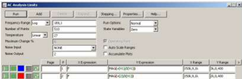
Рисунок 2.39 – Завдання параметрів аналізу для визначення частотної залежності модуля вхідного опору каскаду СЕ
