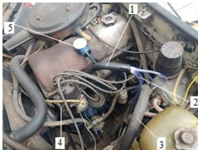
Рисунок 3.3 - Елементи фізичного моделювання газорідинного обміну: a – двигун ВАЗ-2101 навантажувального стенда: 1 – патрубок вентиляції картера; 2 – додаткові патрубки; 3 – скляна ємність; 4 – моторна олива; 5 – блок циліндрів; б – двигун ВАЗ-2101 автомобіля ВАЗ-21063: 1 – патрубок вентиляції картера; 2 – додаткові патрубки; 3 – шланг вентиляції картера, що виведений під днище автомобіля; 4 – блок циліндрів; 5 – манометр вимірювання тиску картерних газів
