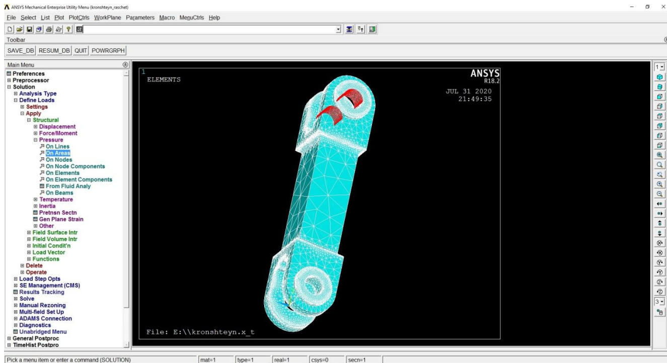
Рисунок 4.13 – Приклад прикладення тиску на деталь
