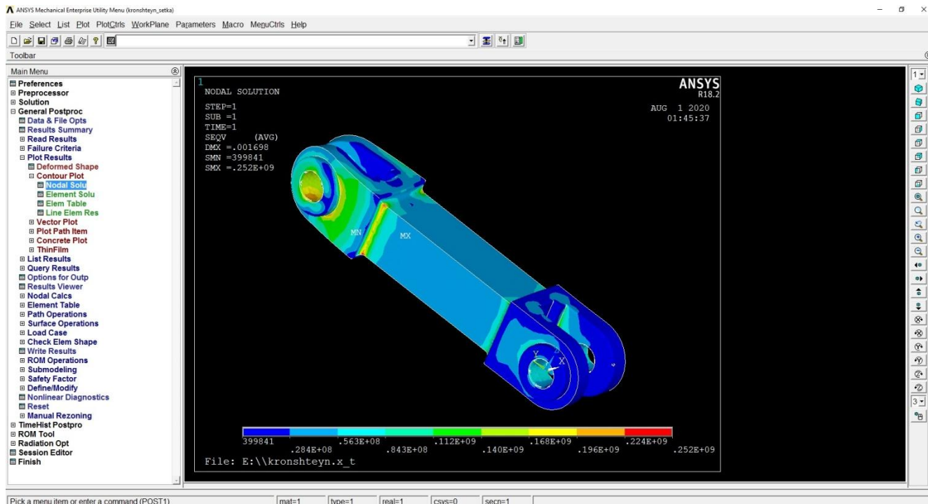
Рисунок 4.23 – Напруження за елементами/вузлами, за Мізесом (МПа) для тиску \sigma_0 = 100 МПа для деталі виготовленої методом ГП ( \sigma_{max} = 252 МПа)
