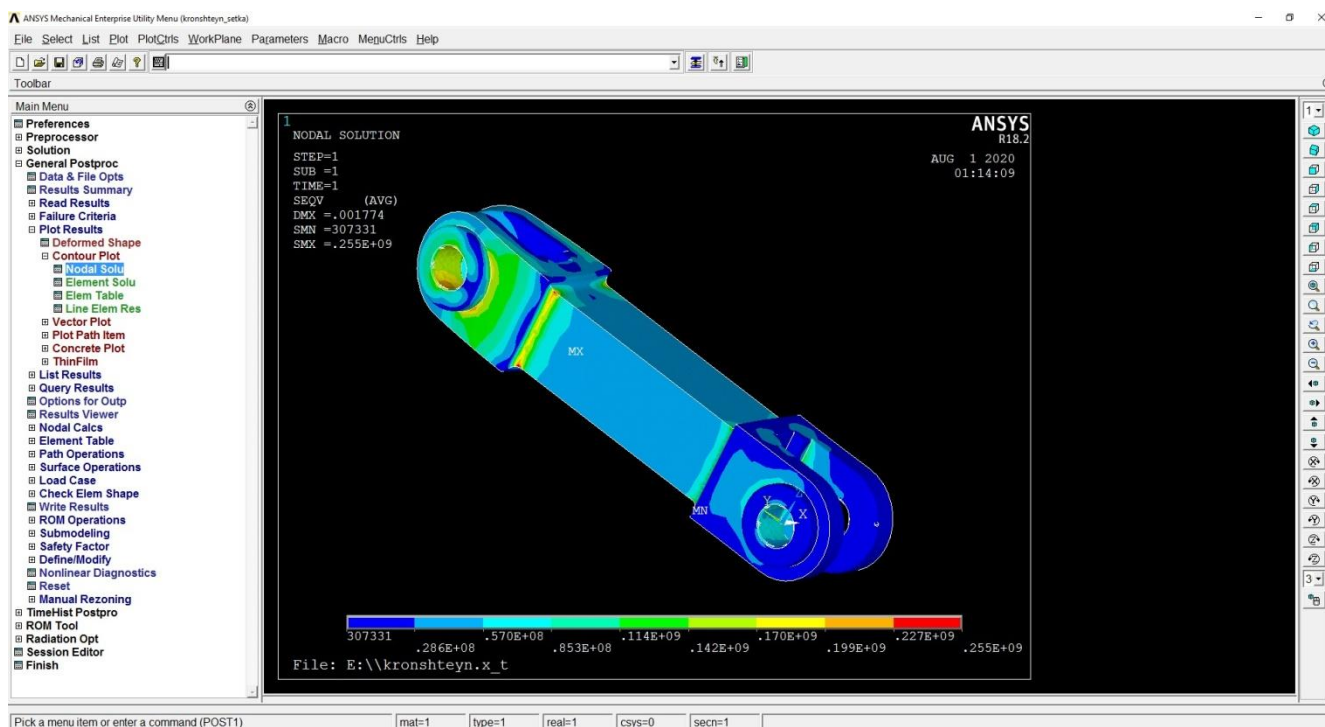
Рисунок 4.20 – Напруження за елементами/вузлами, за Мізесом (МПа) для тиску \sigma_0 = 100 МПа для деталі виробленої методом адитивних технологій ( \sigma_{max} = 255 МПа)
