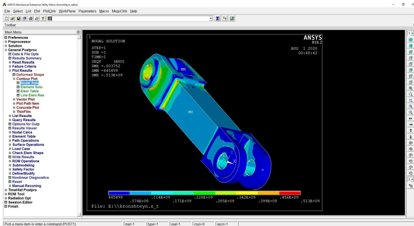
Рисунок 4.15 – Напруження за елементами/вузлами, за Мізесом (МПа) для тиску \sigma_0 = 200 МПа для литої деталі ( \sigma_{max} = 513 МПа)
