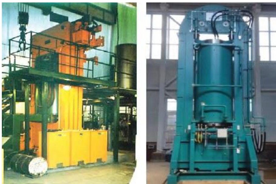
Рисунок 1.7 – Установки газостатичної обробки матеріалів [19]
