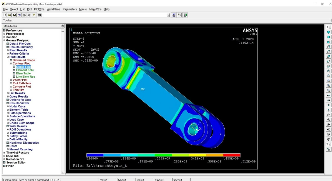
Рисунок 4.18 – Напруження за елементами/вузлами, за Мізесом (МПа) для тиску \sigma_0 = 200 МПа для штампованої деталі ( \sigma_{max} = 512 МПа)
