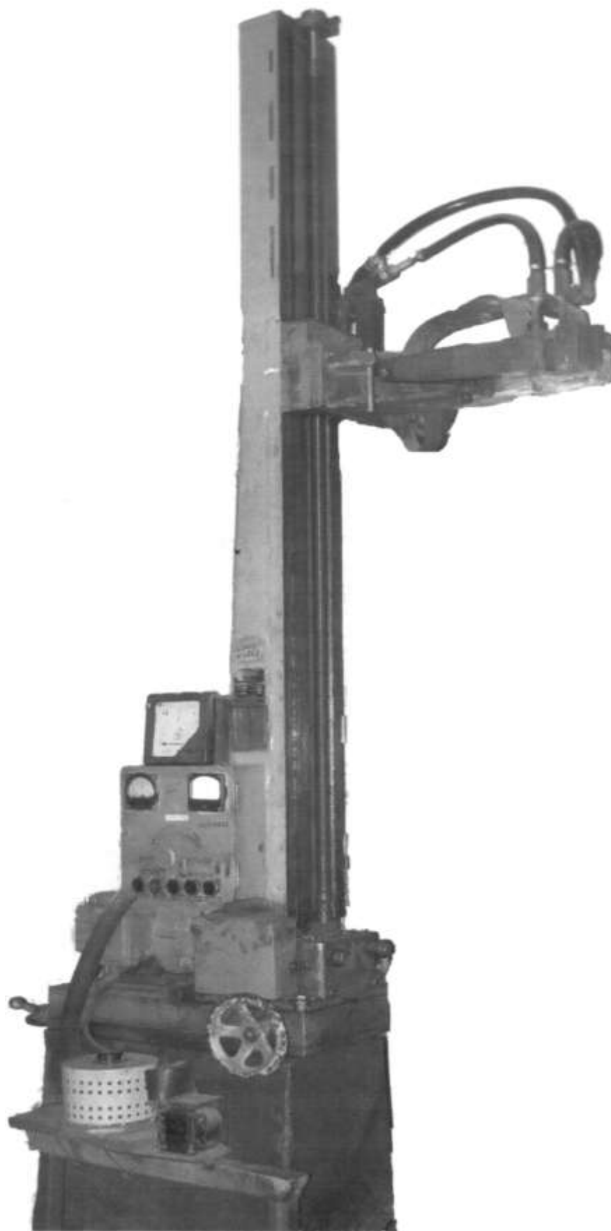
Рисунок 2.3 - электрошлаковая установка А 550
