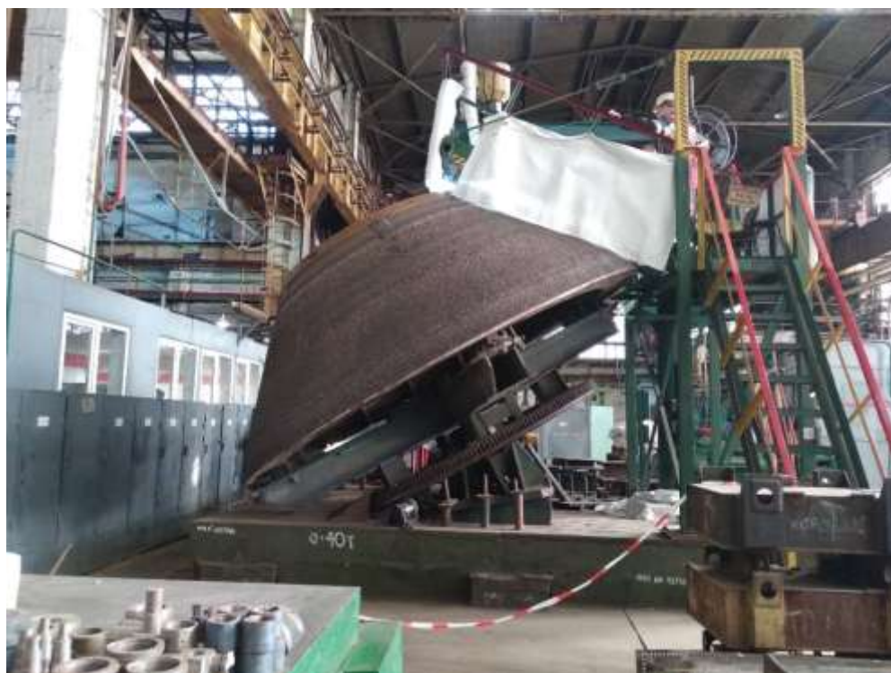
Рисунок 3.30 – Наплавлення конусу ЗАДП
