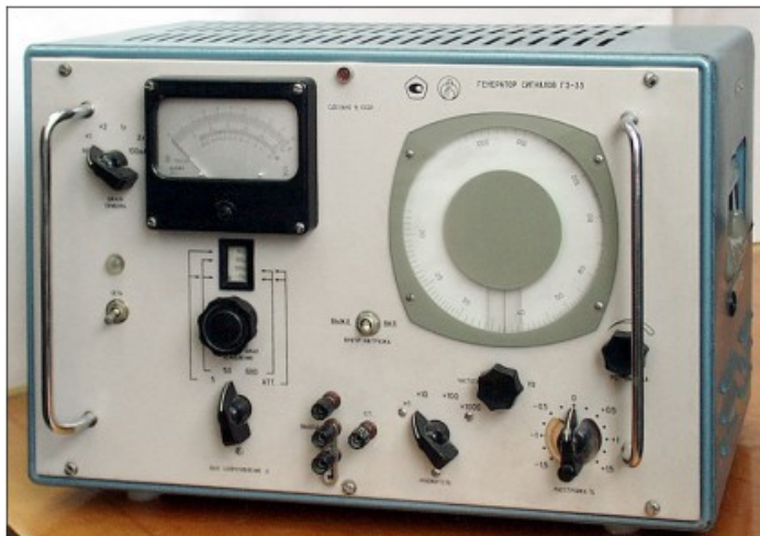
Рисунок 5.2 - Передня панель генератора ГЗ-34
