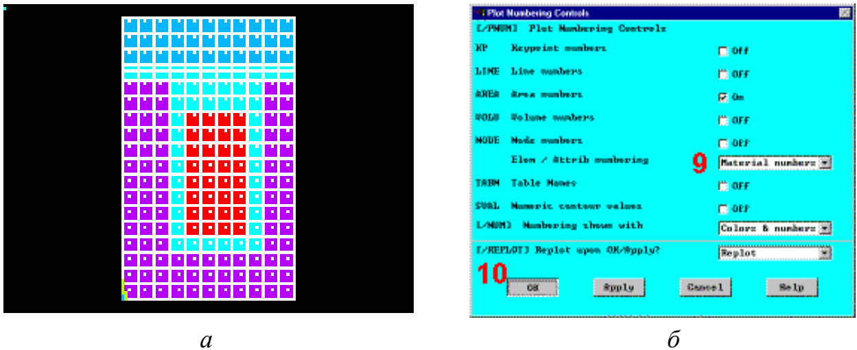
Рисунок 4.21 – Генерування сітки a - виділення всієї області; б – завдання параметрів
