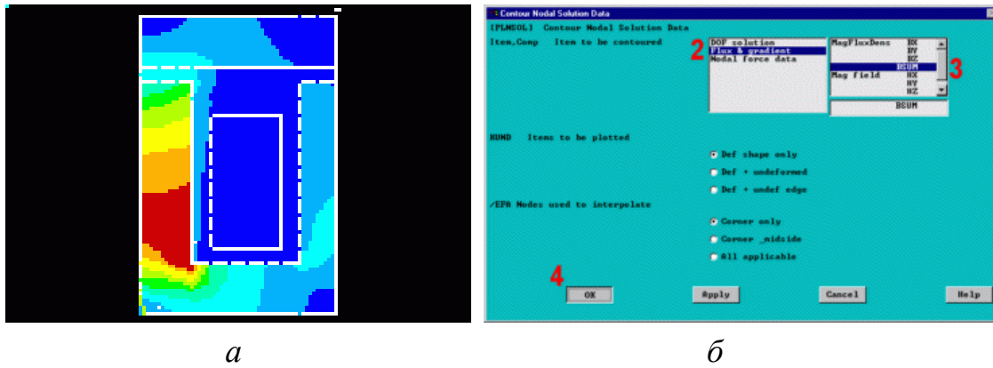
Рисунок 4.32 – Области насичення магнітопровода a – області насичення; б – завдання параметрів
