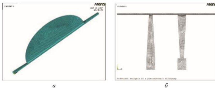
Рисунок 3.4 - Моделі мініатюрного безклапанних п'єзоелектричного насоса з планарним (а) і поперечним (б) розташуванням вводів
