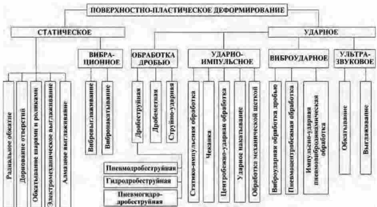
Рисунок 5.2 - Класифікація способів обробно-зміцнюючої обробки поверхонь
