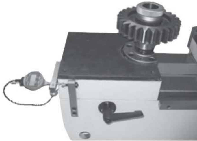
Рисунок 3.1 – Установка цифрової вимірювальної голівки Sylvac з дротяним інтерфейсним з'єднанням з комп'ютером на міжцентромірі
