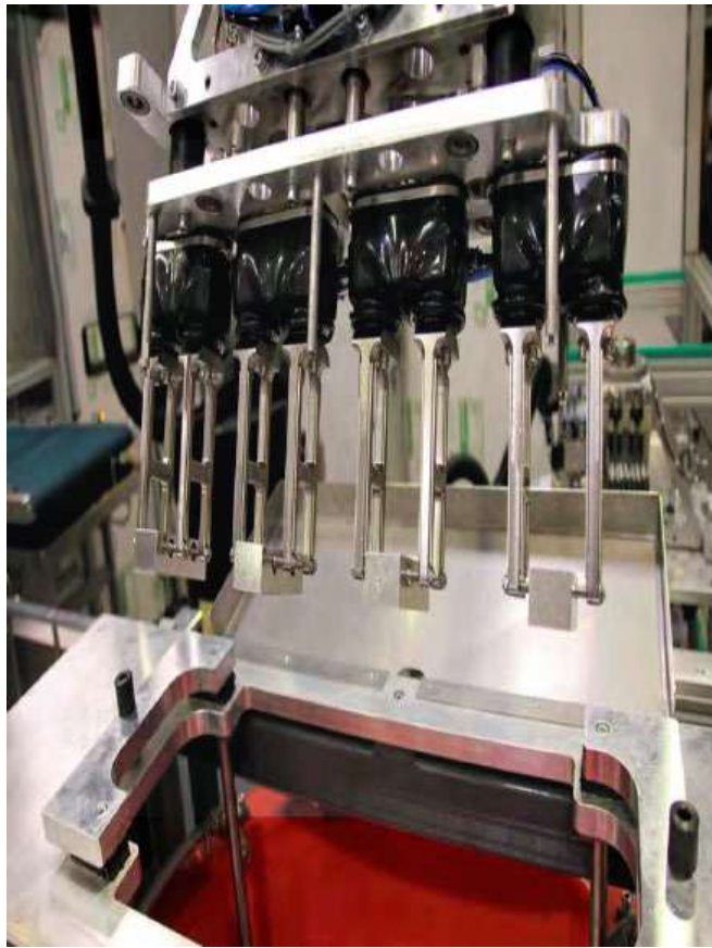
Рисунок 4.7 - Захват для розташування деталей, що обертаються, у віброуючій масі абразивних тел
