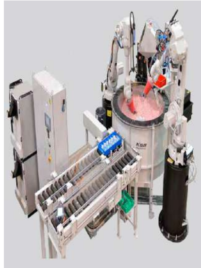
Рисунок 4.6 - Роботизована установка Surf - Finisher для видалення задирок.
