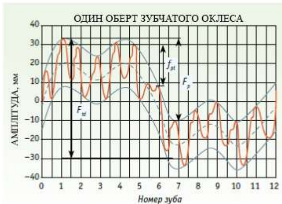
Рисунок 3.2 – Графічна інтерпретація результатів автоматизованого контролю на міжцентромірі
