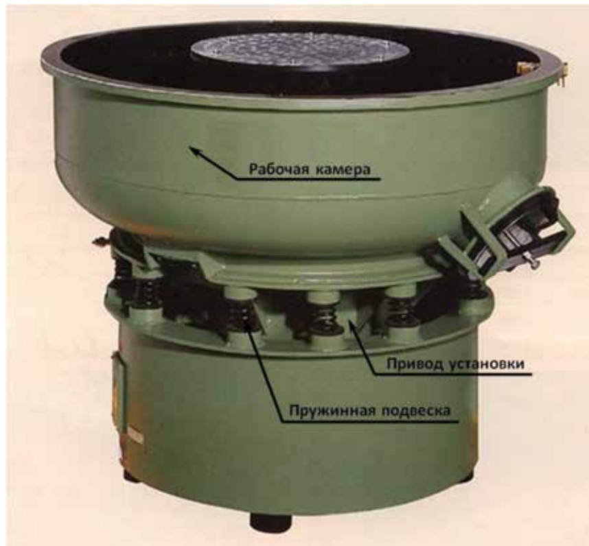
Рисунок 3.3 – Тороїдальна віброполірувальна установка [12]
