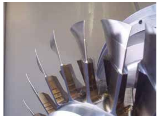
Рисунок 5.10 – Умовні технологічні границі при фрезеруванні моноколеса компресора ГТД [34]
