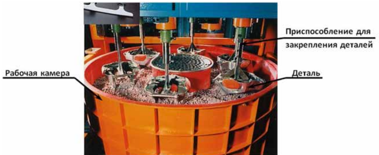
Рисунок 3.5 – Тороїдальна віброполірувальна установка з закріпленням оброблюваних деталей [12]
