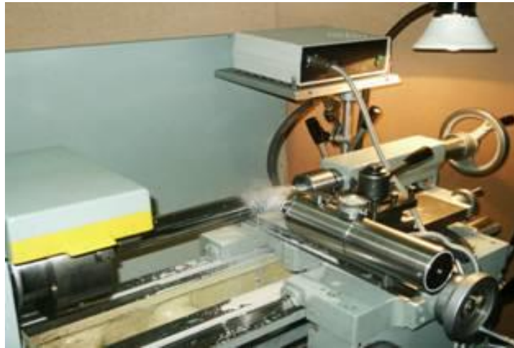
Рисунок 5.15 – Процес безабразивної ультразвукової фінішної обробки
