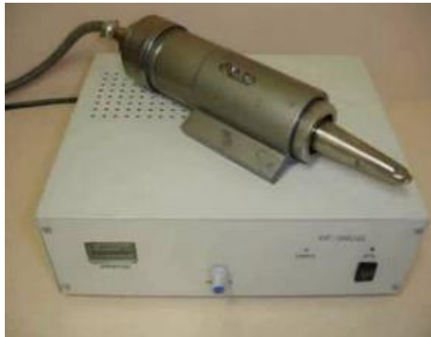
Рисунок 5.13 – Загальний вигляд пристрою для безабразивної ультразвукової фінішної обробки ИЛ 4–0,63
