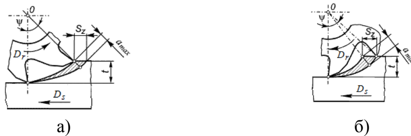
Рисунок 3.1 - Схеми зміни товщини шару, що зрізається при зустрічному (а) та попутному (б) фрезеруванні
