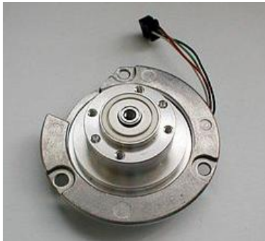
Рисунок 1.5 – Електродвигун шпинделя магнітних пластин
