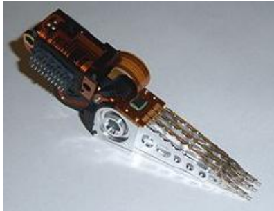
Рисунок 1.4 – Блок магнітних голівок із системою позиціювання
