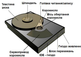
Рисунок 1.1 – Структура жорсткого диску
