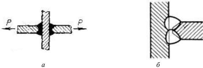
Рисунок 2.8 – Таврові з'єднання з повним проваром [2]
