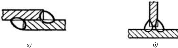
Рисунок 2.1 – Напускове (а) і таврове (б) зварні з'єднання
