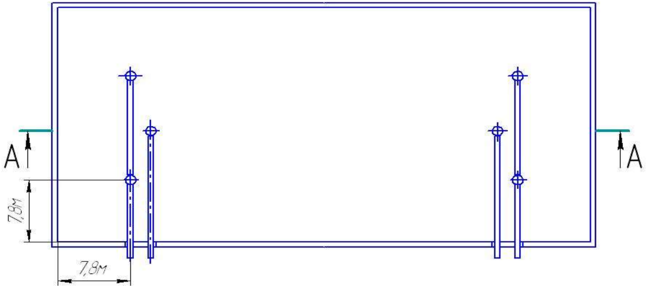
Рисунок 2.9 – Схема точок розвантаження пневмотранспорту
