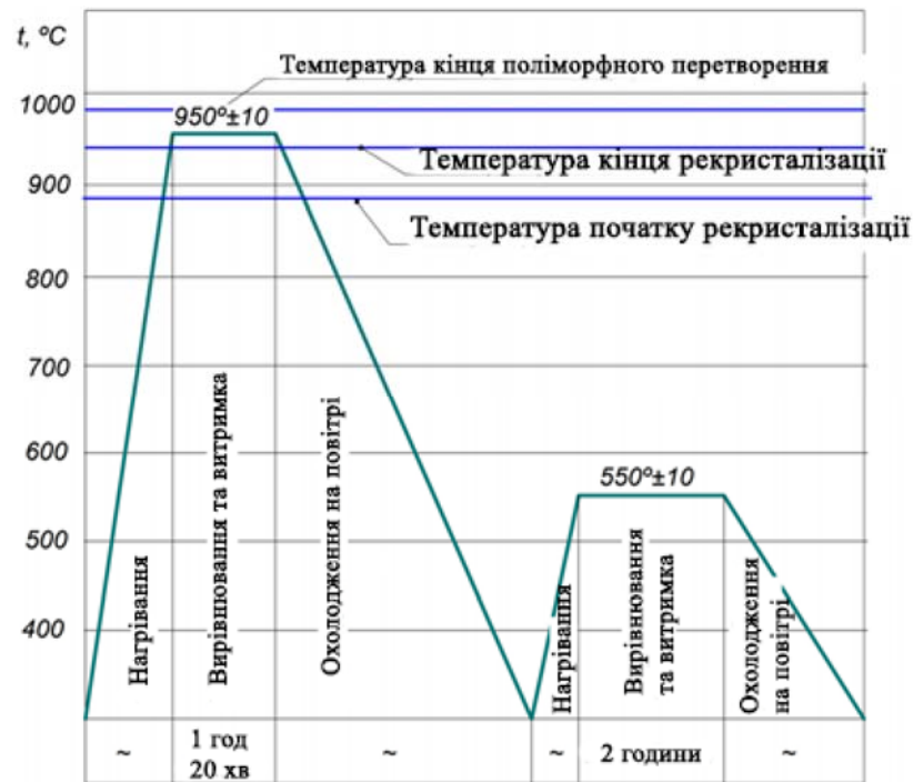
Рисунок 3.4 - Режим подвійного відпалу зразків зі сплаву ВТЗ-1
