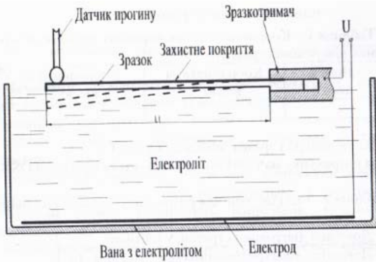
Рисунок 4.4 – Схема закріплення та виміру деформації зразка
