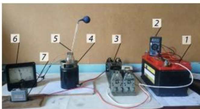
1 - акумуляторна батарея ; 2 - мультиметр для визначення напруги; 3 - реостат для зміни опору; 4 - обмотка збудження статора; 5 - капілярна трубка; 6 - амперметр для визначення сили струму; 7 - вимикач Рисунок 2. Методичне забезпечення дослідних робіт
