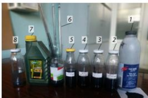
1 - магнітоактивні частинки; 2 - рідина з C_{\text{мч}} = 2,4\% ; 3 - рідина з C_{\text{мч}} = 4,7\% ; 4 - рідина з C_{\text{мч}} = 9,1\% ; 5 - рідина з C_{\text{мч}} = 13\% ; 6 - капілярна трубка; 7 - амортизаторна рідина АЖ-12Т; 8 – індустріальна олива И-40А Рисунок 1. Матеріали для виготовлення магнітоактивних рідин
