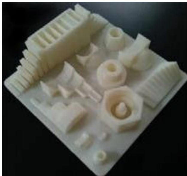
Рисунок 3.4 – Надрукований дослідний зразок на Dimension Elite 3D принтері [Benchmarking of FDM machines through part quality using IT grades]
