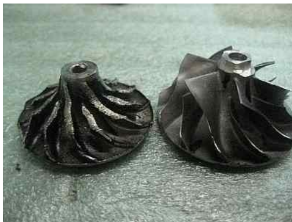
Рисунок 2.4 - Дефект лопаток крильчатки
