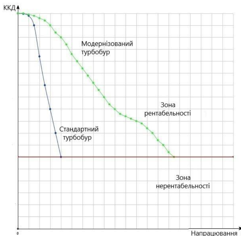
Рисунок 2.6 - Графік залежності ККД турбобура від часу напрацювання
