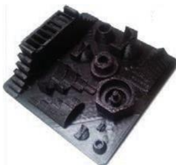
Рисунок 3.5 – Надрукований дослідний зразок на 3D Touch принтері [Benchmarking of FDM machines through part quality using IT grades]
