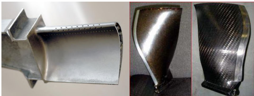
Рисунок 1.8 - Лопатки постійного (а) та змінного (б) перерізу
