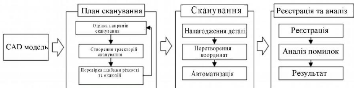
Рисунок 2.13 – Загальний алгоритм обробки інформації, отриманої з лазерної системи безконтактного контролю
