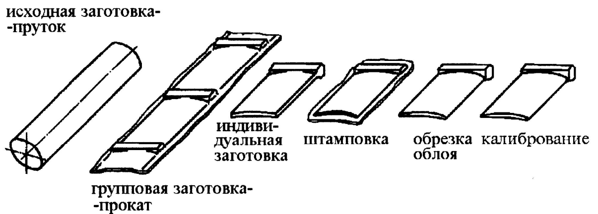
Рисунок 1.4 – Послідовність технологічних переходів точного штампування робочих лопаток компресора із прутка
