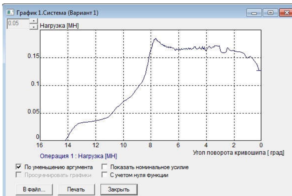
Рисунок 3.35 – Графік залежності зусилля видавлювання від кута повороту кривошипу пресу при температурі нагрівання t 1000^{\circ}\text{C}
