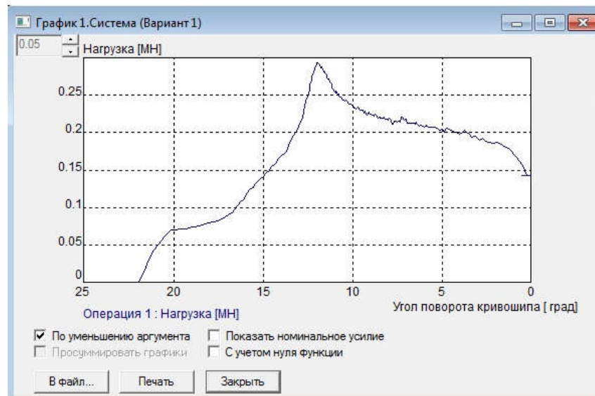
Рисунок 3.21 – Графік залежності зусилля видавлювання від кута повороту кривошипу пресу при температурі нагрівання t 850^{\circ}\text{C}
