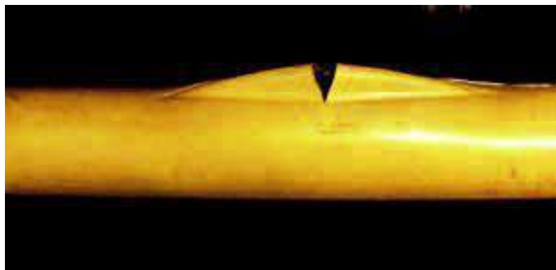
Рисунок 1.5 - Розрив деформованої зони в локальному розширенні ділянки
