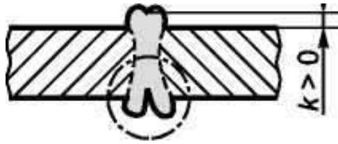
Рисунок 1.11 - Западина в зварному з'єднанні
