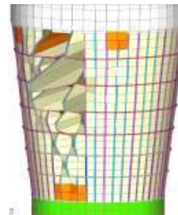
Рисунок 12 – Теоретична форма руйнування
