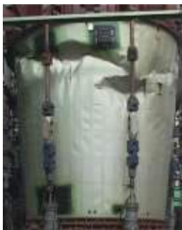
Рисунок 11 – Експериментальна форма руйнування
