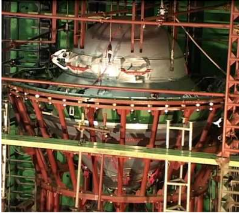
Рисунок 21 – Загальний вигляд експериментальної установки (початок руйнування паливного відсіку)
