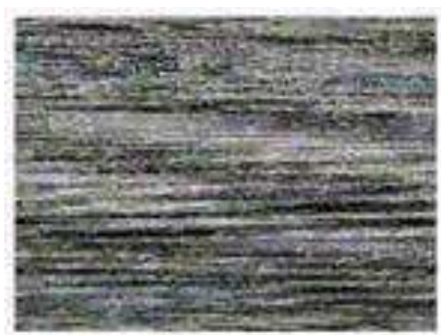
Рисунок 2.11 – Екран пристрою відображення при подаванні відеосигналу спотвореного по принципу Line Cut & Rotate
