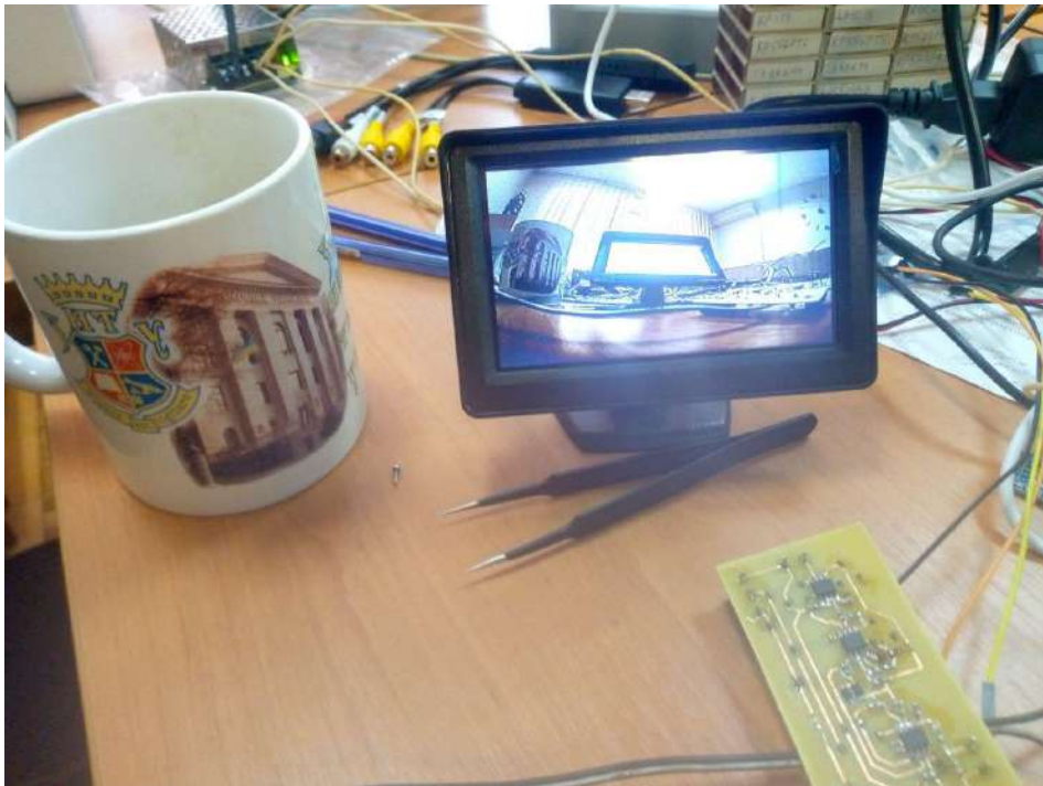
Рисунок 3.15 – Тестування роботи системи бездротової передачі відео з наявним шифруванням розробленим методом (приймальна сторона)
