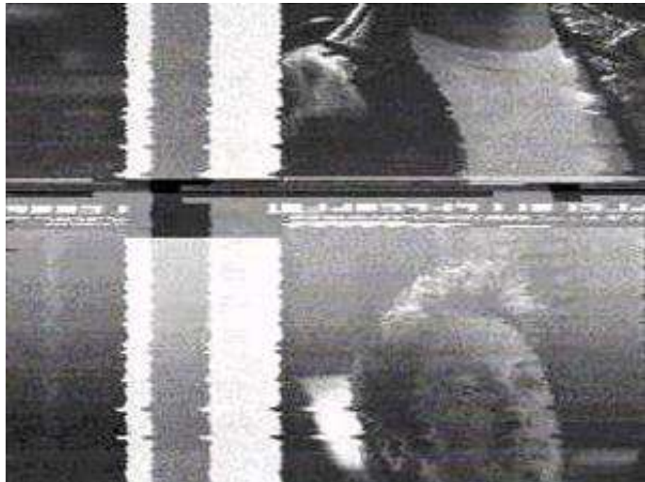
Рисунок 2.6 – Вид екрана при прийомі сигналу з скремлюванням Sync Suppression
