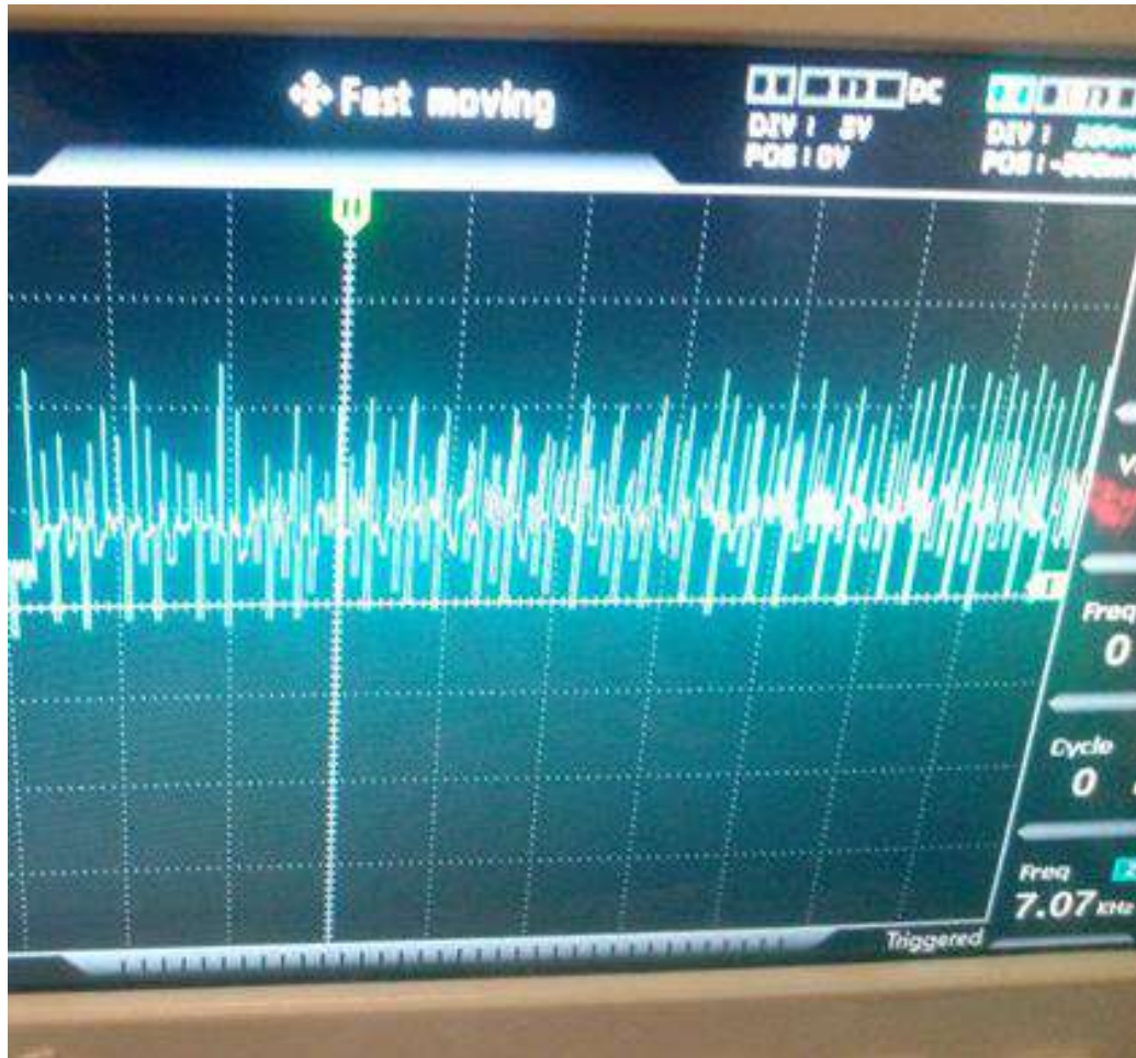
Рисунок 3.18 - Осцилограма, знята з виходу хаотичного скремблера на роз'ємі X3 за відсутності вхідного відеосигналу.
