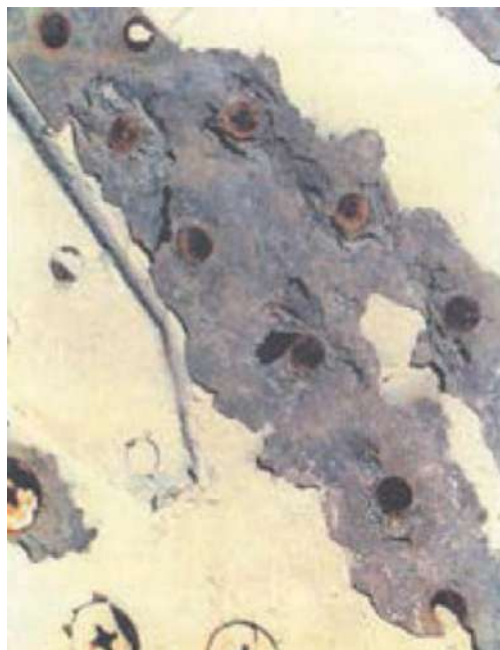
Рисунок 1.7 – Корозія у місцях встановлення кріпильних елементів фюзеляжу
