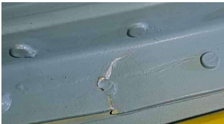
Рисунок 1.4 – Втомна тріщина стрингера фюзеляжу
