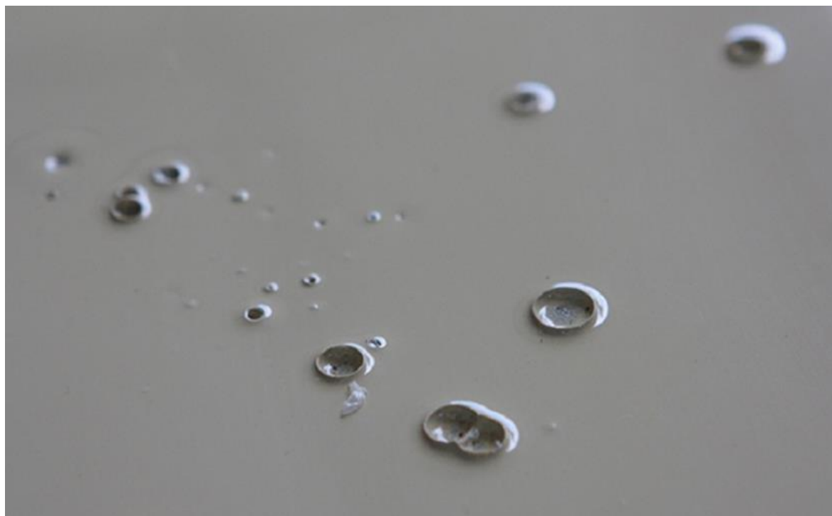
Рисунок 2.4 – Дефекти порошкового покриття у вигляді кратерів
