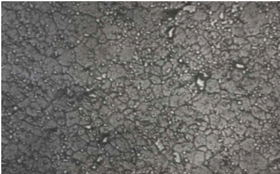
Рисунок 3.2 — Коагуляція карбідів хрому
