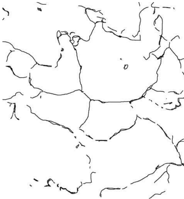
Рисунок 3.5 — Різкий зріст зерна фериту
