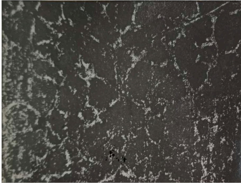
Рисунок 3.3 — Виділення карбідів хрому
