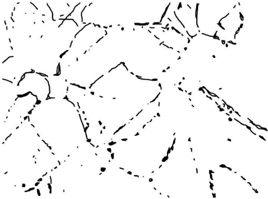
Рисунок 3.6 — Зменшення кількості карбідів хрому
