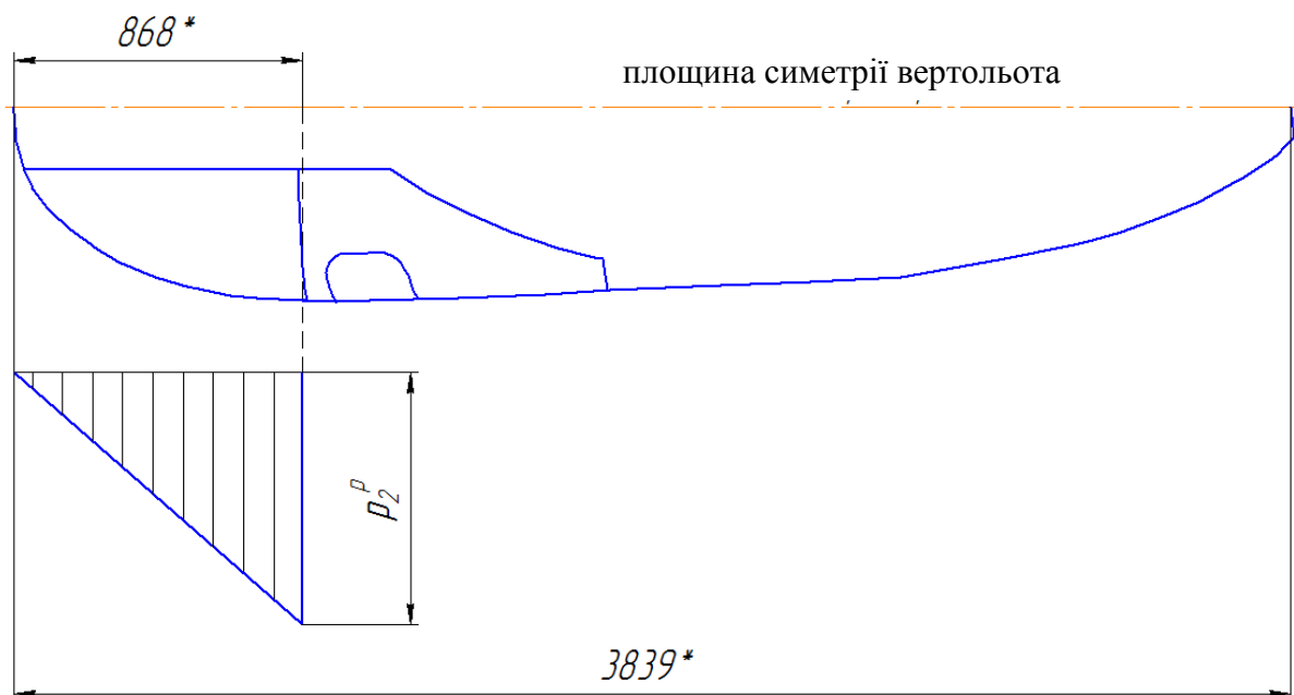
Рисунок. 4.2 – Розподілення тиску по поверхні капоту двигуна переднього
