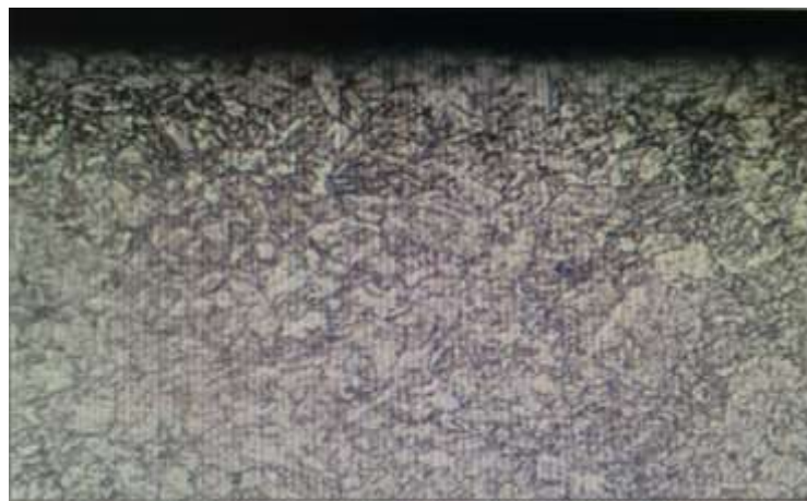
Рисунок 3.1 – Мікроструктура поблизу поверхні зубців; x500.
