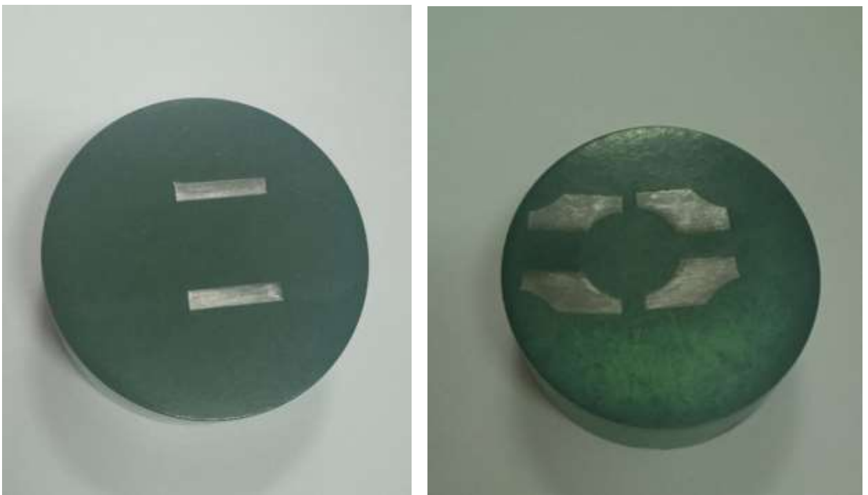
Рисунок 2.3 – Фото зразків залитих у пластмасову форму
