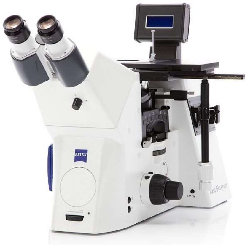
Рисунок 2.2 – Фото металографічного мікроскопу Axioobserver D1M.
