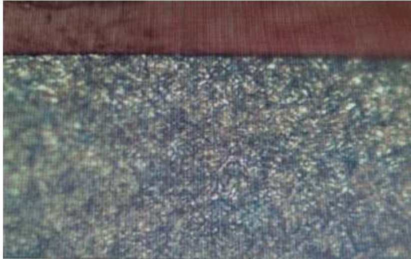
Рисунок 3. 9 – Мікроструктура нітроцементованого шару; x500.
