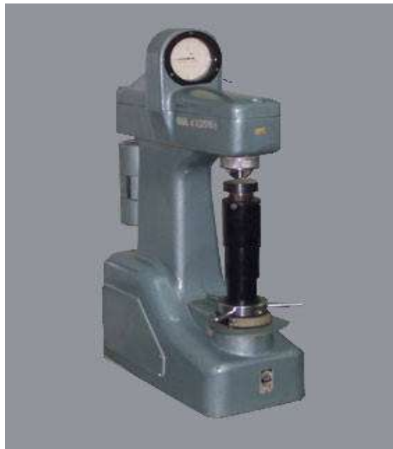
Рисунок 2.4– Твердомір для металів ТК-2.
