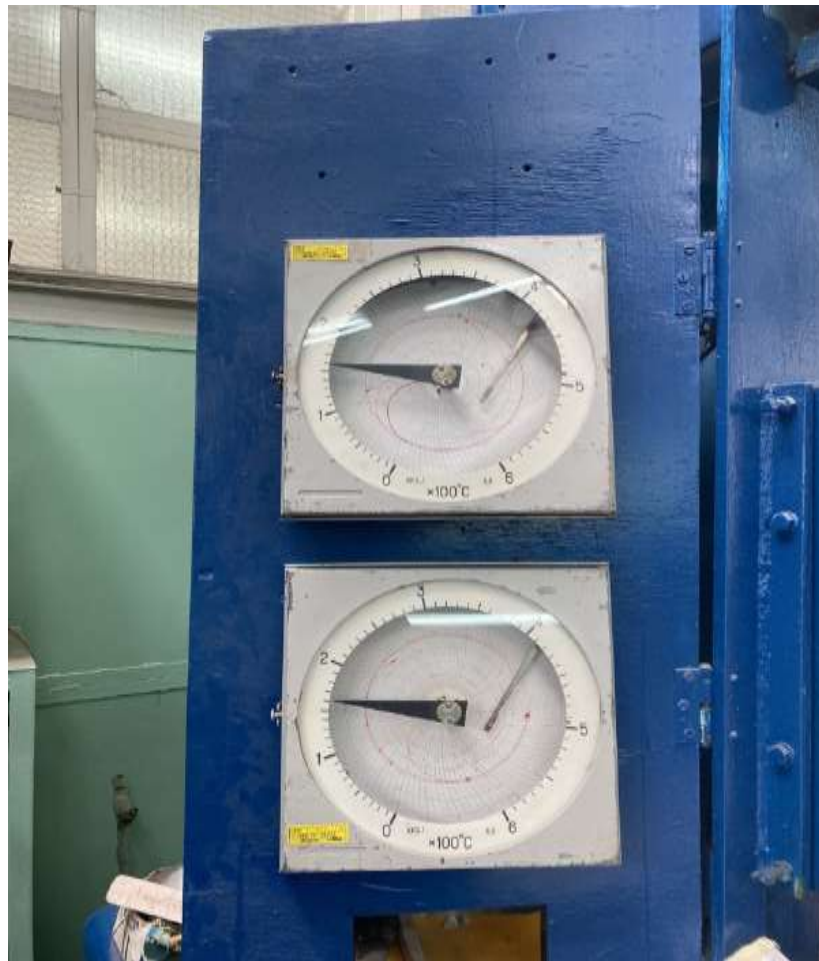
Рисунок 4.6 - Контрольний прилад для відстеження температури.
