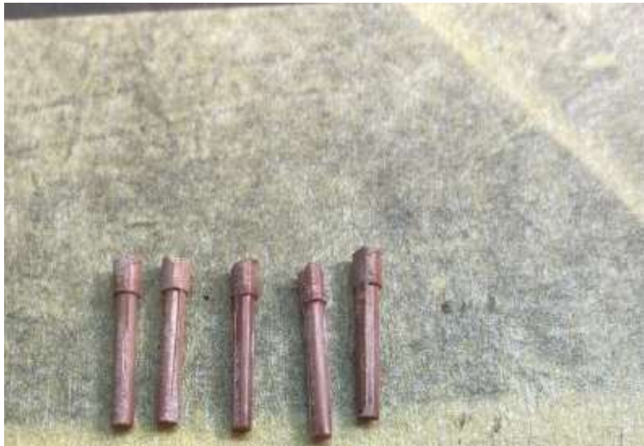
Рисунок 4.11 - Відформовані ПУ зачищені (без дефектів).
