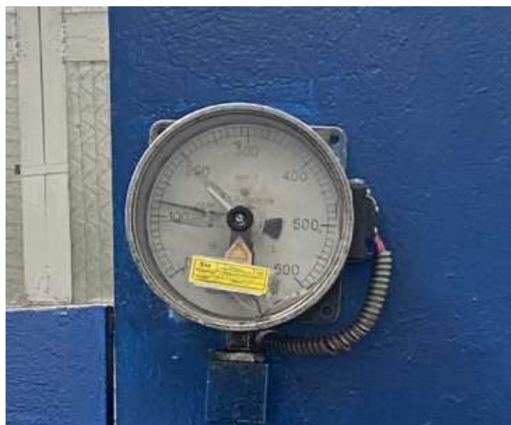
Рисунок 4.7 - Манометр (прилад для замірювання тиску та його відстеження)
