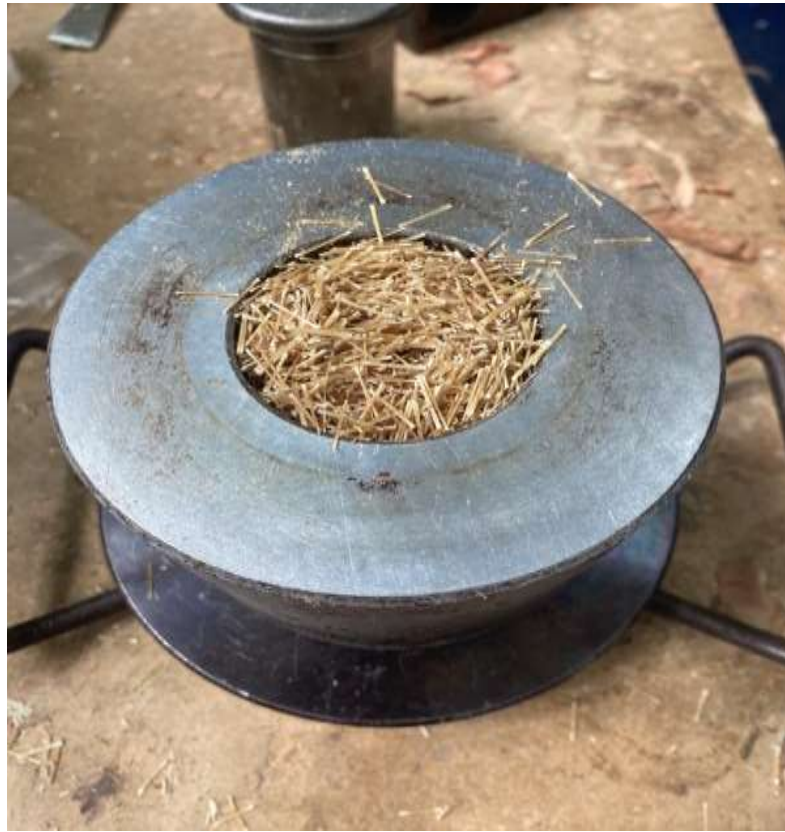
Рисунок 4.4 - Завантаження ДСВ в робочу камеру.
